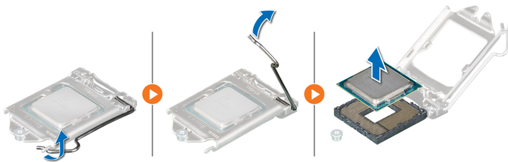
Ilustración 43. Extracción del procesador
