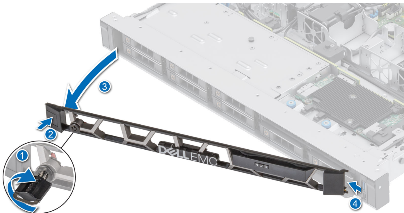
Ilustración 9. Extracción del bisel frontal con el panel LCD
