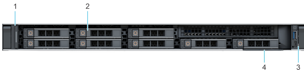
Ilustración 1. Vista frontal de un sistema de 8 unidades de 2,5 pulgadas
